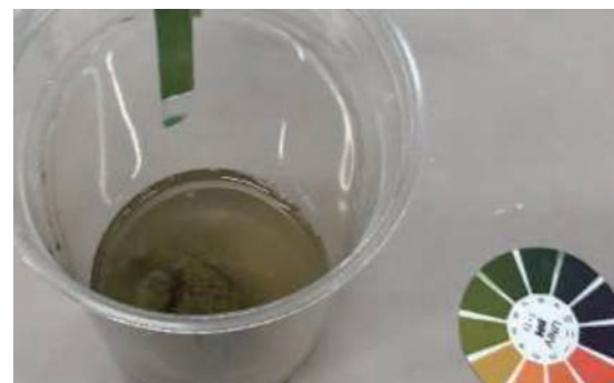
写真-4 中性固化材の pH 測定結果 (pH7)
