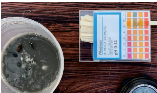
写真-2 緩結材+土の pH 測定結果 (pH5~6)
