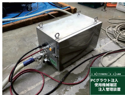
写真-10 注入管理装置
