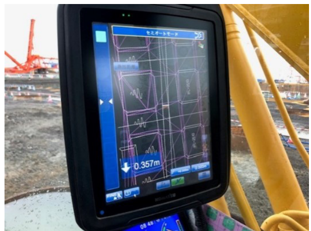
写真-9 ICT 建機操縦状況
