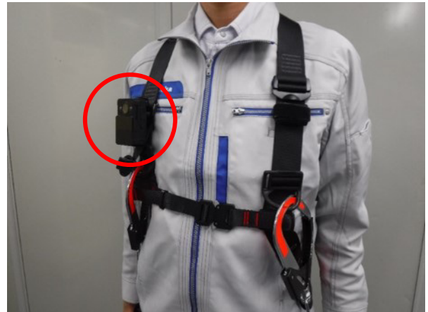
写真-14 ウェアラブル Web カメラの装着状況
