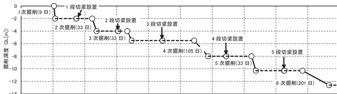
図-4 解析に用いた掘削工程
