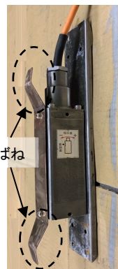
写真-2 差動トランス式傾斜
