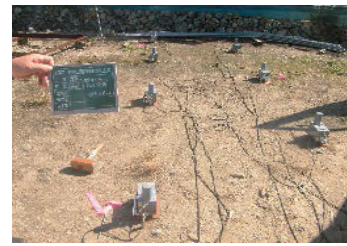
写真-2 微動チェーンアレイ探査の状況
