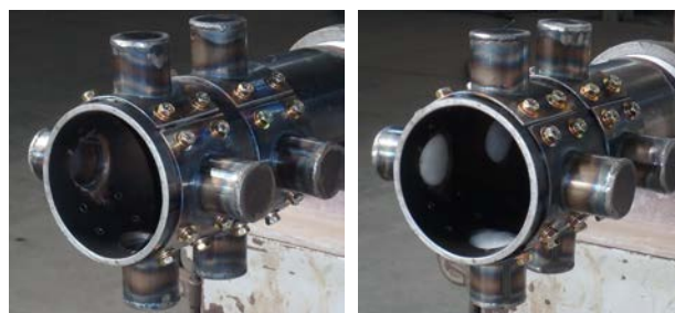
音響管のみ 通気フィルター設置
