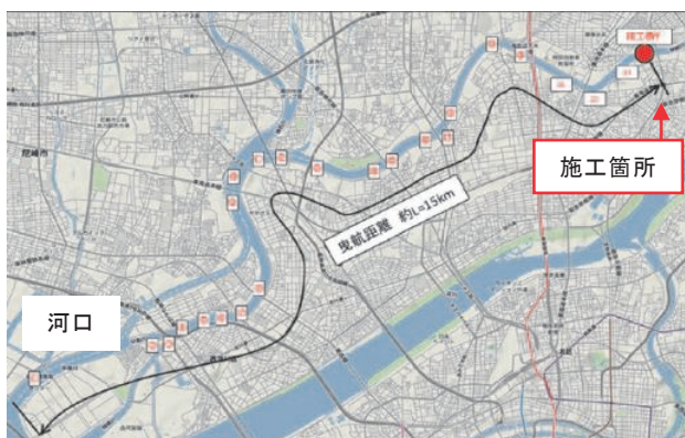
図-4 使用船舶・資機材搬入時のルート調査位置
