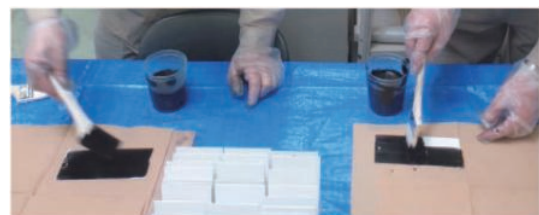
写真-2 汚染処理の状況（懸濁液）
