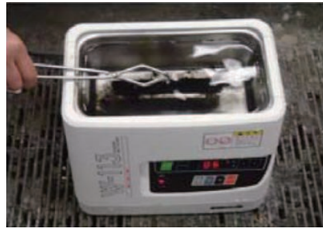
写真-3 超音波洗浄機による除去中の塗装試験体
