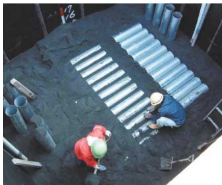
配管の埋設処分実験(水平設置)
