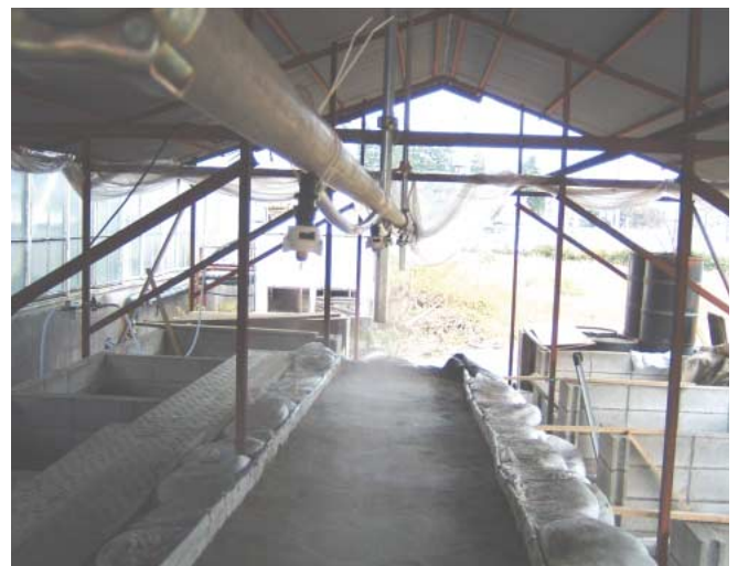
キャッピングシステムによる雨水浸透制御実験(当社技術研究所)
